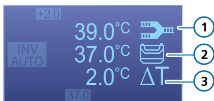
Figura 13. Janela Monitoração da temperatura
