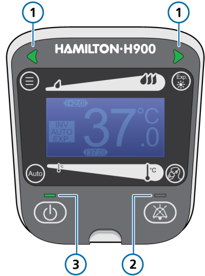
Figura 4. Umidificador HAMILTON-H900, indicadores de estado do painel frontal
