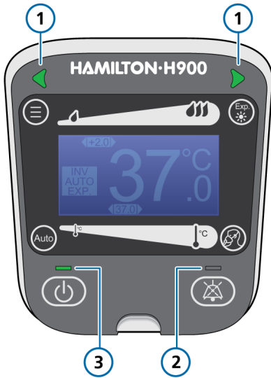
Abbildung 4. HAMILTON-H900 Befeuchter, Statusanzeigen am Bedienfeld
