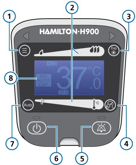
Abbildung 3. HAMILTON-H900 Befeuchter, Elemente am Bedienfeld
