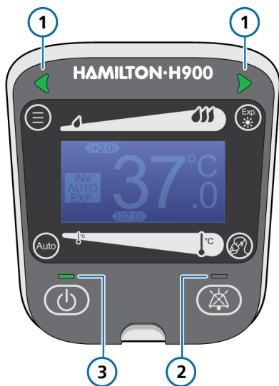
Figure 4. Humidificateur HAMILTON-H900, voyants d'état du panneau avant
