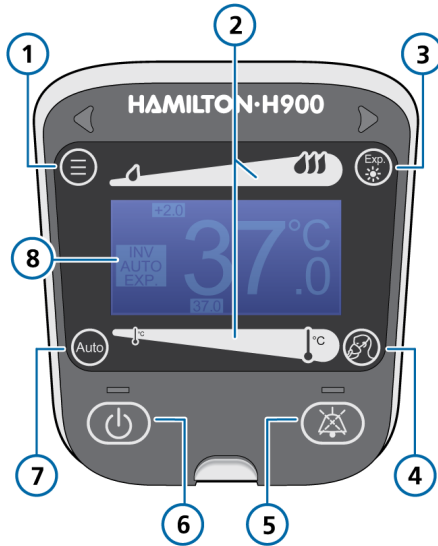
Figura 3. Umidificador HAMILTON-H900, controles do painel frontal
